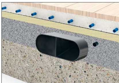
Flachkanal in der Ausgleichsschicht (nach DIN 18560-2)
