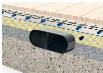
Flachkanal teilweise in der Ausgleichsschicht und Estrich mit Bewehrung
