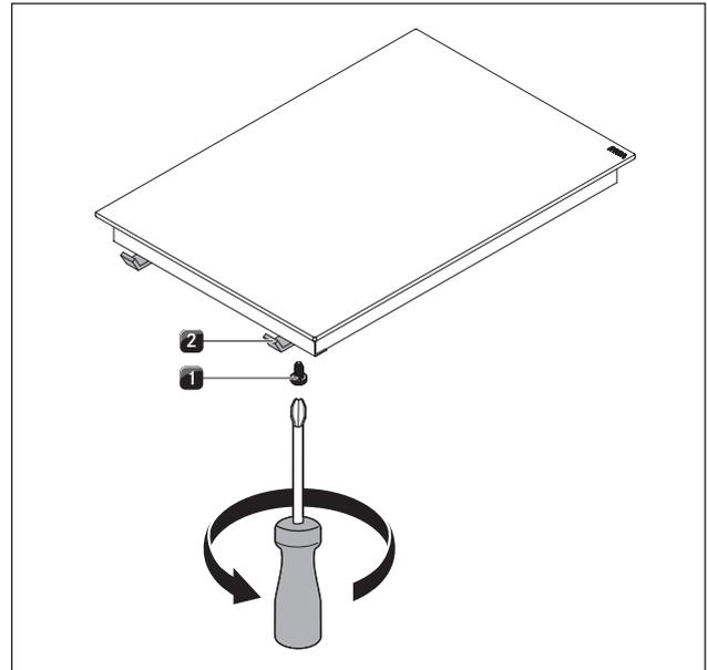
Abb. 5.16 Befestigungsklammern
