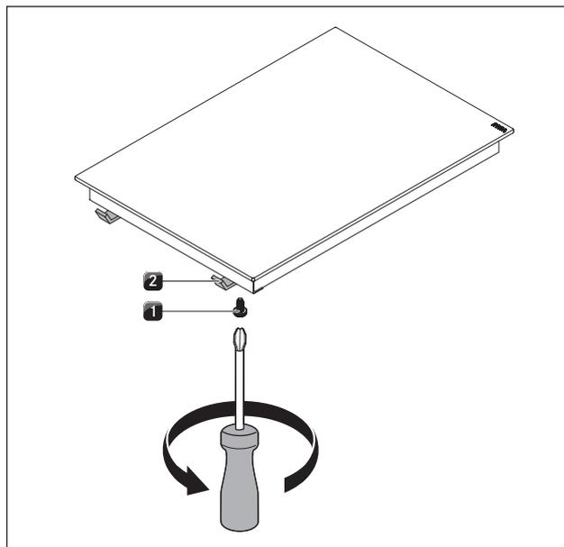
Abb. 5.16 Befestigungsklammern
