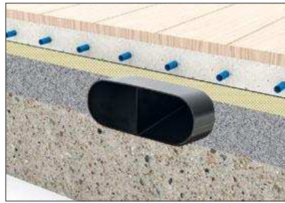
Flachkanal teilweise in der Schüttung und Estrich mit Bewehrung (nicht nach Norm)
