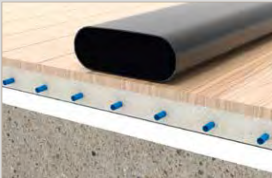
Flachkanal auf Bodenbelag
