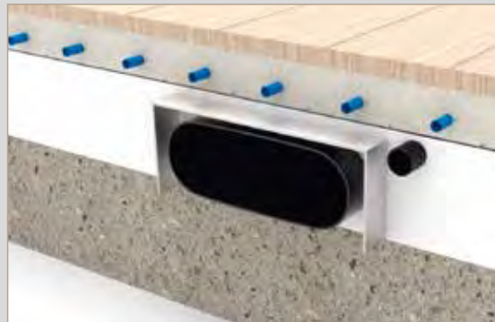
Flachkanal in der Trittschalldämmung
