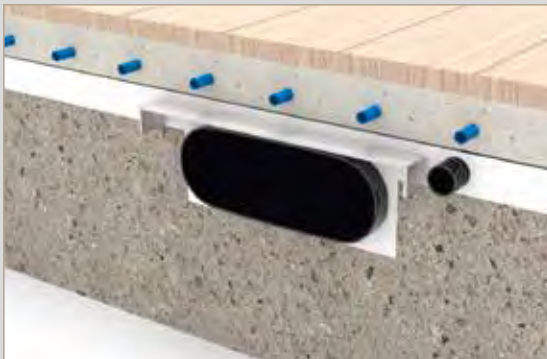
Flachkanal in Trittschalldämmung und Stahlbetondecke
